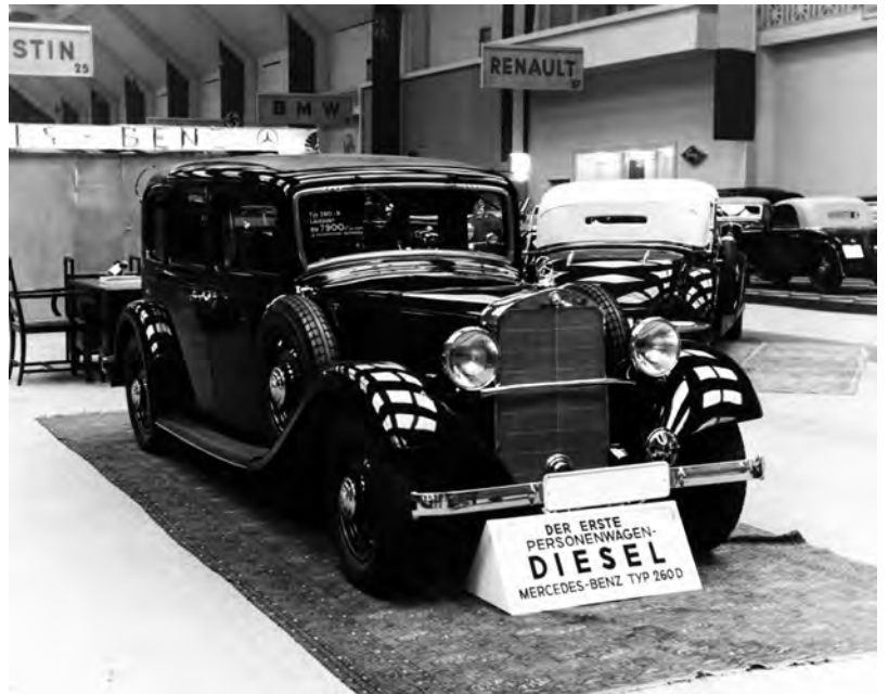
El Mercedes-Benz 260 D (o Mercedes-Benz W138) es el primer automóvil de pasajeros producido en serie con un motor diesel de Mercedes-Benz, 1937.
